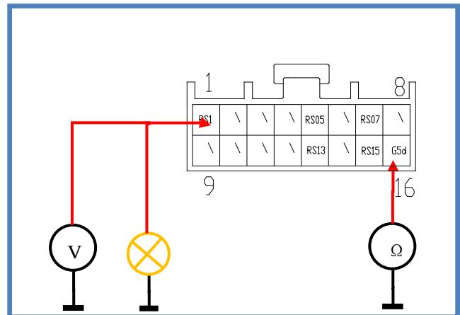
2 ) 点火开关 ON , 挂倒档 , 1#为蓄电池电压 , 用试灯测试 ,
